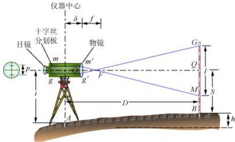
图 视线水平时的视距测量
