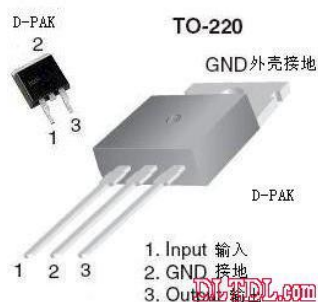
图 10 三端集成稳压芯片 LM7805 引脚图
